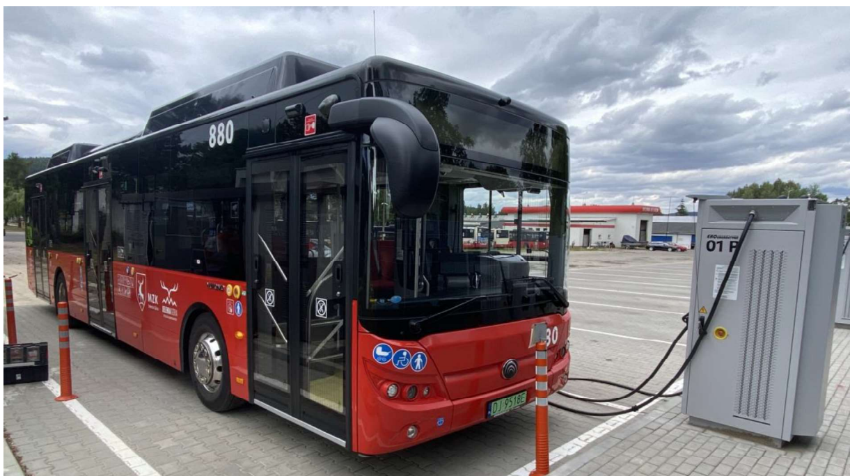
Rys. 9.2 W pełni niskopodłogowy zeroemisyjny autobus MAXI w trakcie ładowania
