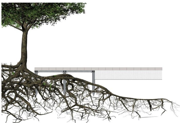
Ryc. 35 Przekrój nawierzchni podwieszanej, Źródło: ArborGrid - system ochrony strefy korzeniowej i istniejących drzew - Green City Life - Zielone dachy, retencja i drzewa w mieście ( gcl.com.pl )
